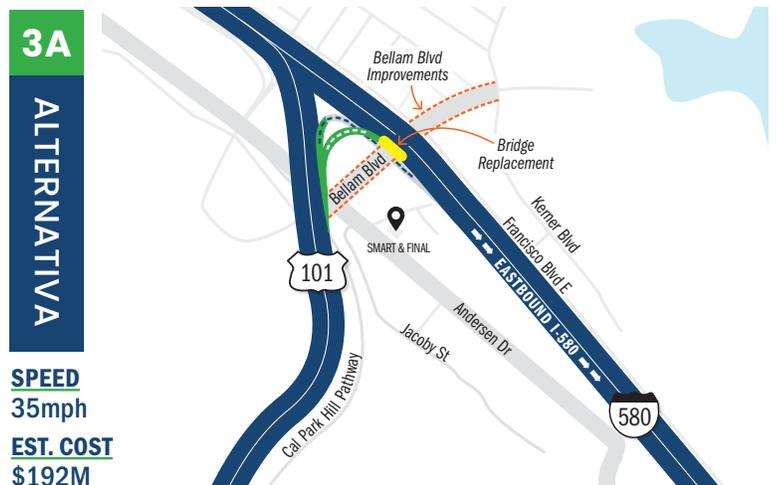
Los conductores salen de US 101 hacia el norte cerca de Bellam Boulevard, cruzan sobre la salida existente de US 101 hacia el norte / I-580 hacia el este y se fusionan con I-580 hacia el este.
