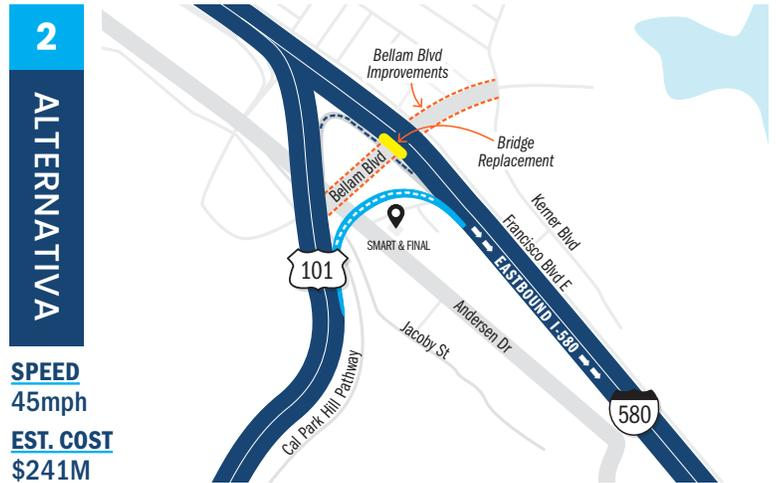
Los conductores salen de US 101 hacia el norte entre Cal Park Hill y Bellam Blvd. Una nueva estructura de puente cruzará Andersen Drive antes de fusionarse con I-580 hacia el este.
